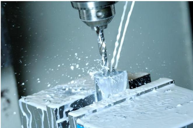
Abbildung 1: Anwendung eines Kühlschmierstoffes beim Bohren
