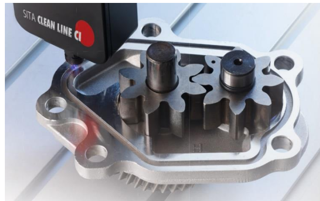
Abbildung 2: Inline-Kontrolle der umlaufenden Klebenut
