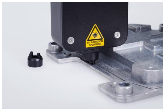
Abbildung 1: Händische Messung mit SITA CleanoSpector und Abstandhalter direkt auf der Klebenut
